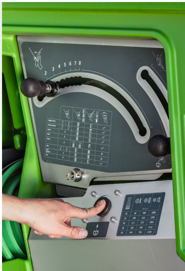
✓ ElectricDrive серийно оснащен практичным тумблером калибровки на SmartCenter
