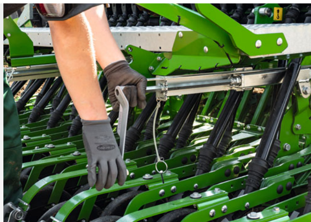
Простая настройка глубины укладки справа и слева в задней части Cataya Special
