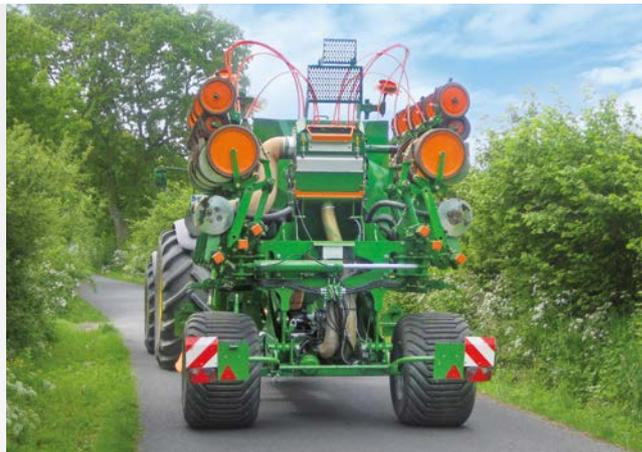
Благодаря хитроумному механизму складывания все сеялки точного высева EDX можно очень быстро привести в транспортное положение с шириной 3 м.
