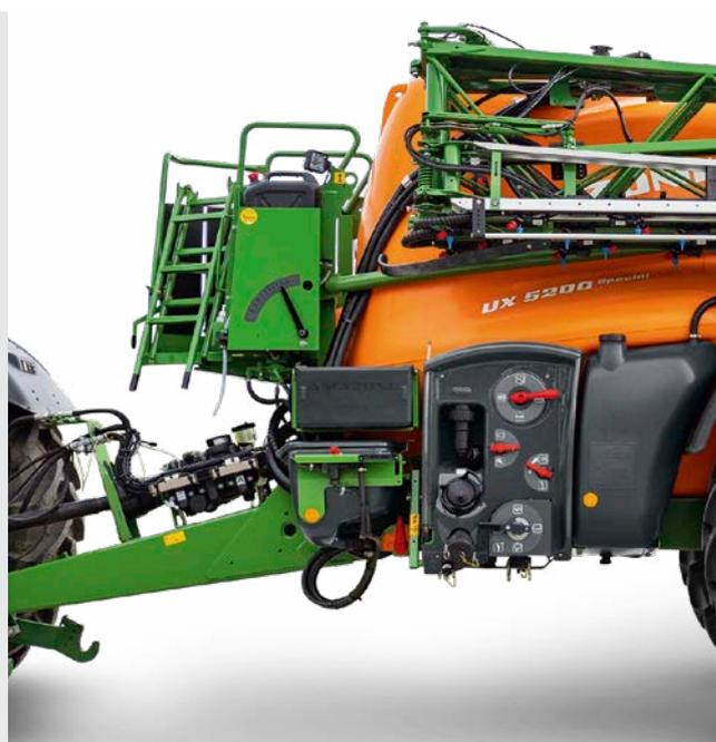
✔ Широкая платформа обеспечивает удобный доступ и безопасное положение
