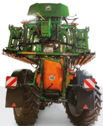
☑ С углом поворота 20° оси управляемых колес прицепных опрыскивателей UX Special идеально преодолевают также узкие повороты.
