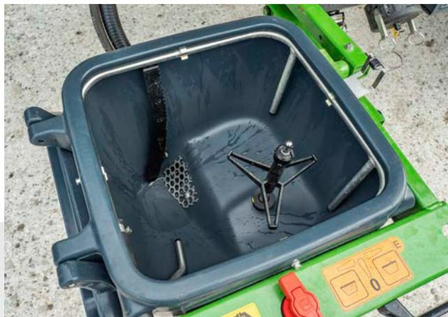
Высокопроизводительный промывочный бак обеспечивает минимальное время на загрузку и однородную смесь раствора
