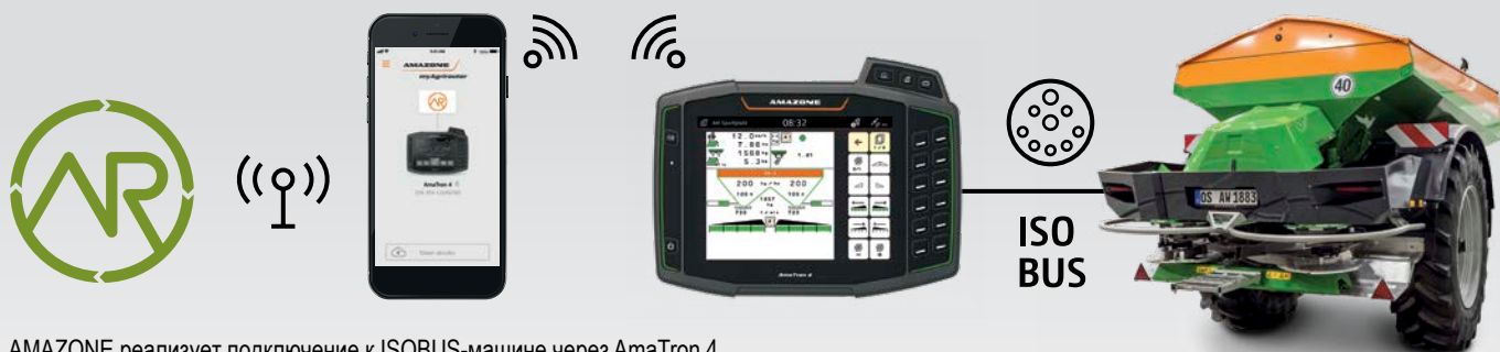
AMAZONE реализует подключение к ISOBUS-машине через AmaTron 4
