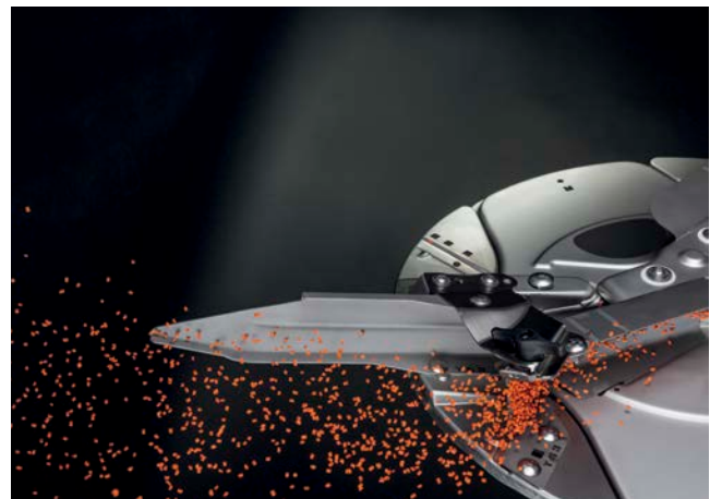
AutoTS – настройка направляющей лопатки для пограничного распределения
