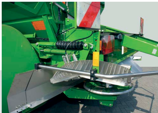
Приподнятая система пограничного распределения Limiter
