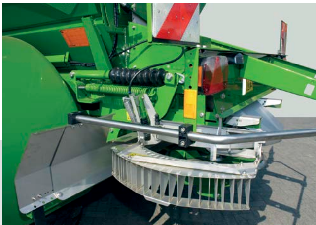
Система пограничного распределения Limiter в рабочем положении
