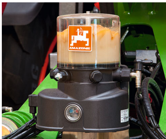
Насос с резервуаром для смазки
