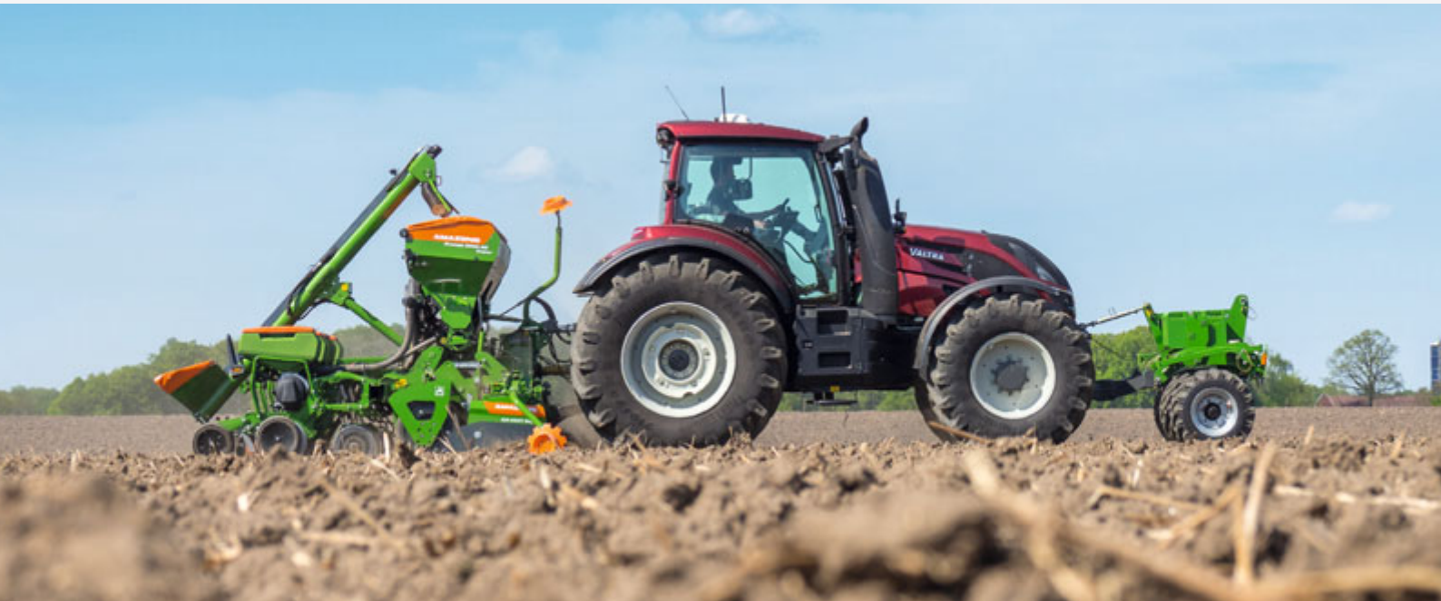
Ротационный культиватор KG 3001 Super с сеялкой точного посева Precea 3000 AC
