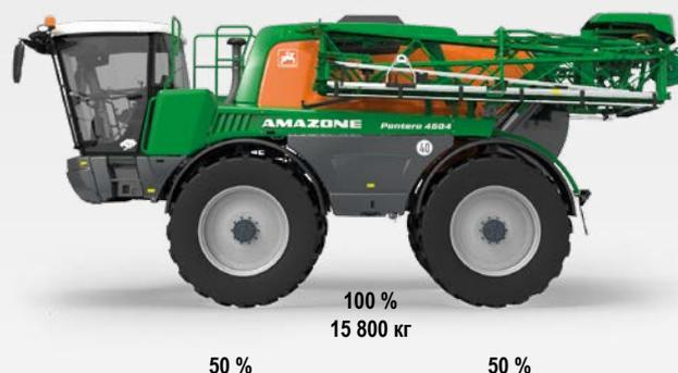
Распределение массы в заполненном и разложенном состоянии
