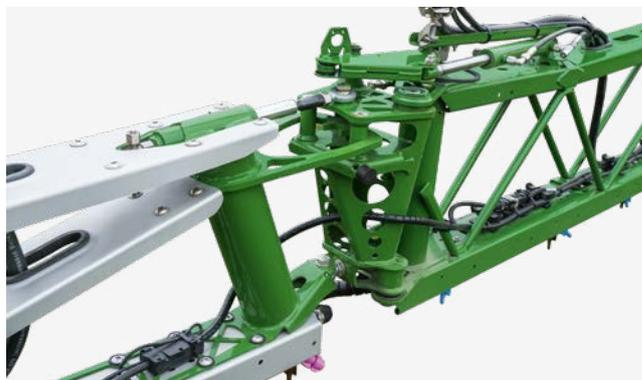
Предохранительный механизм крайней секции с гидравлическим преднатяжением (по принципу «салунной двери») может отклоняться назад, вперед и вверх и гарантирует надежный возврат в исходное положение и долгий срок службы.
