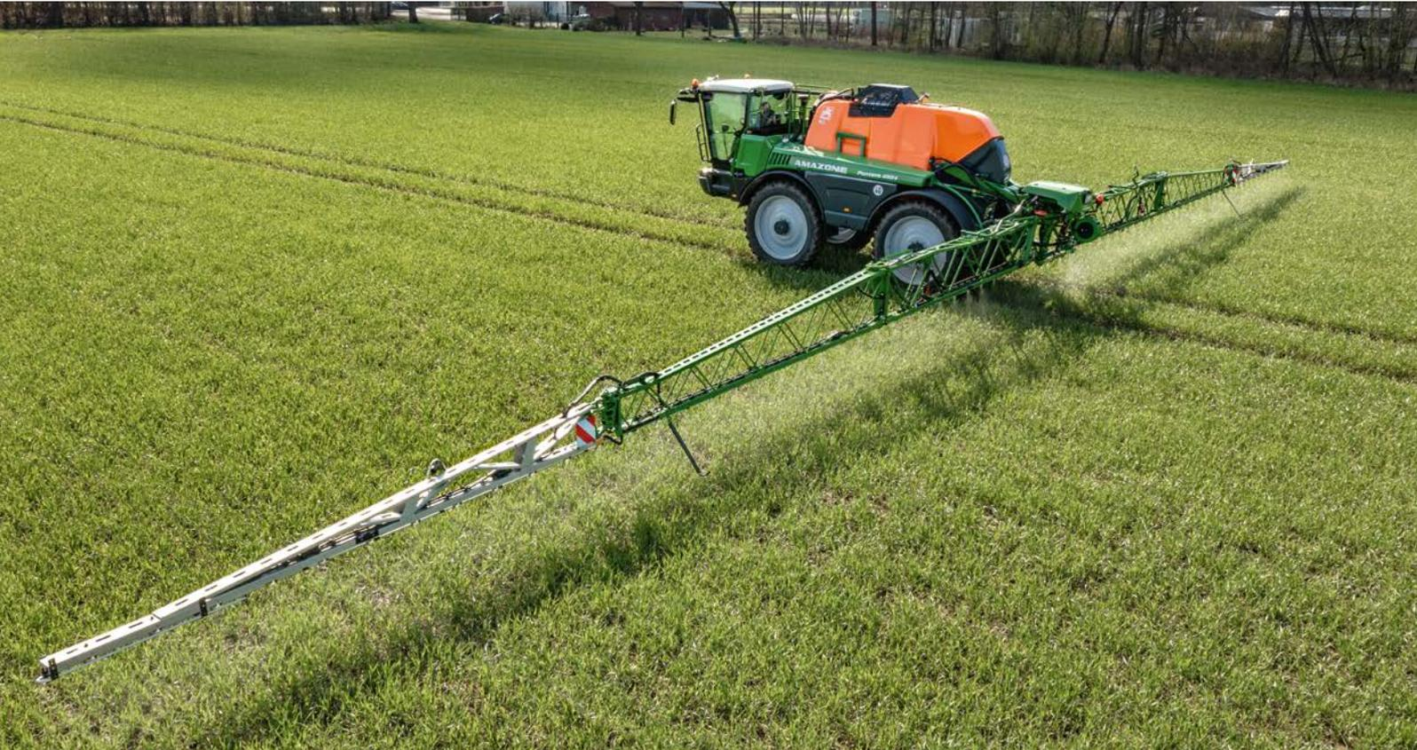
Большой диапазон регулировки по высоте от 0,35 м до 2,65 м за счет параллелограммной подвески (на Pantera 4504 с шинами 380/90 R50)
