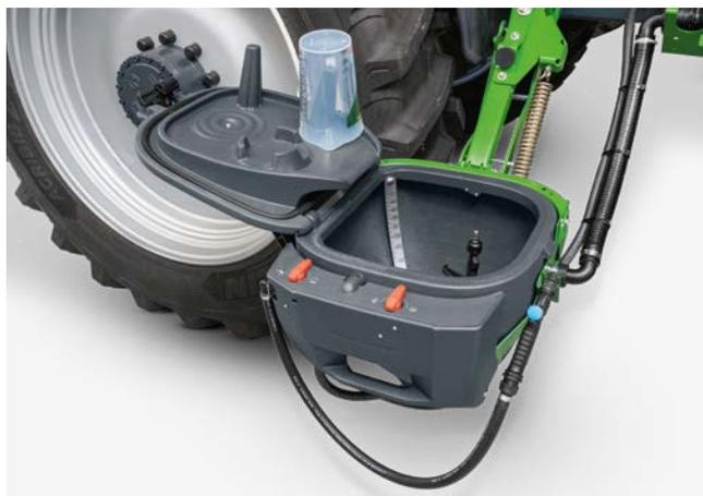
На крышке установлен держатель для мерного стакана или канистры, для стекания жидкости после промывки.
