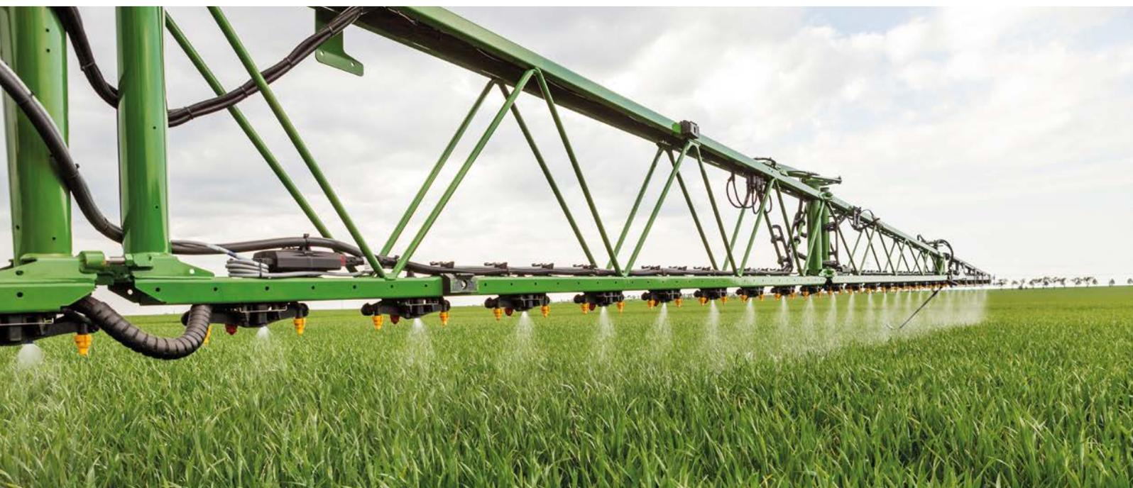
Оснащение шлангами для внесения удобрений для пофорсуночного включения AmaSwitch с 4-корпусным креплением форсунок и комплектом для смещения на штанге Super-L2
