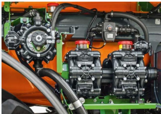
Насос для чистой воды (160 л/мин) находится рядом с двумя мощными мембранно-поршневыми насосами (520 л/мин)
