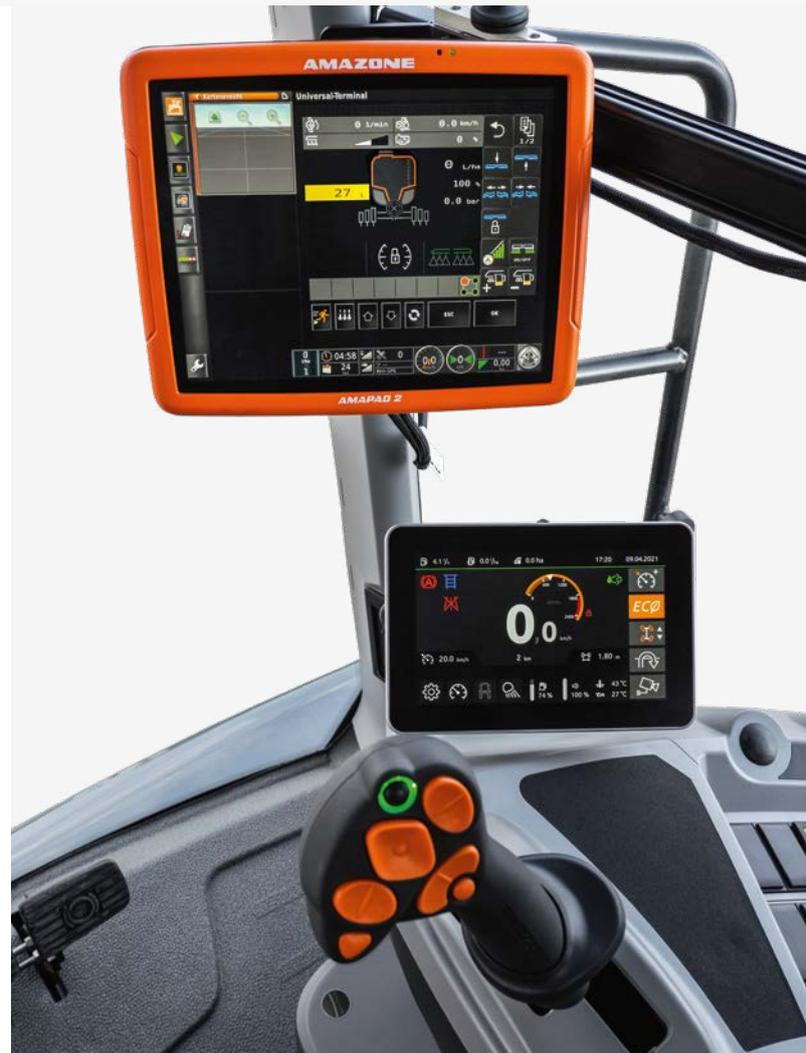
Решение с двумя терминалами: ISOBUS-терминал AmaPad 2 и терминал шасси AmaDrive 7.0, а также многофункциональный джойстик AmaPilot<sup>+</sup>
