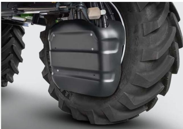
Щитки мотор-колес на Pantera-H и Pantera-HW
