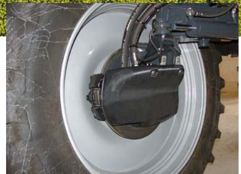
✔ Серийные щетки мотор-колес на Pantera 4504
