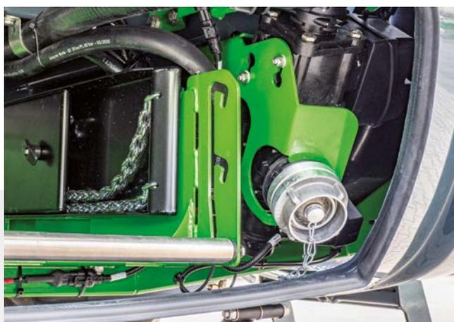
☑ Муфта для заполнения в отсеке для хранения с функцией автоматической остановки
