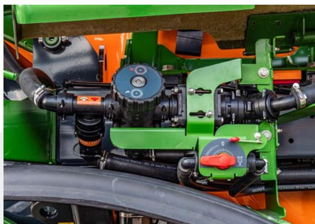
☑ Система HighFlow<sup>+</sup> оснащена дополнительным самоочищающимся фильтром тонкой очистки
