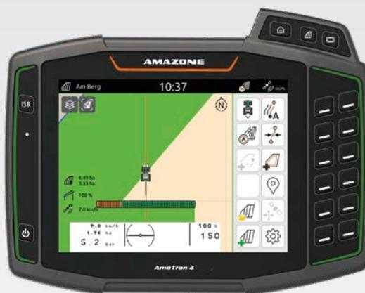
Если на терминале есть функция Section Control, как например, посекционное включение GPS-Switch от AMAZONE, то включение секций может происходить автоматически и в зависимости от GPS-положения. Если поле заложено, то механизматор может в автоматическом режиме полностью сконцентрироваться на управлении трактором, поскольку включение секций на клиньях и на разворотной полосе происходит автоматически.
