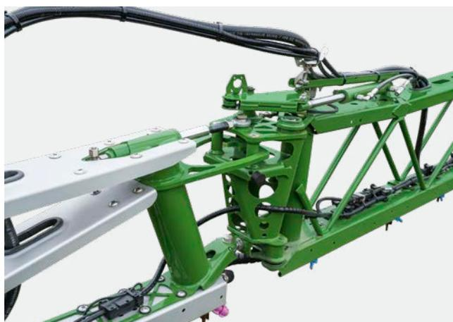
Предохранительный механизм крайней секции с гидравлическим преднатяжением по принципу «салонной двери» может отклоняться назад, вперед и вверх и гарантирует надежный возврат в исходное положение и долгий срок службы.
