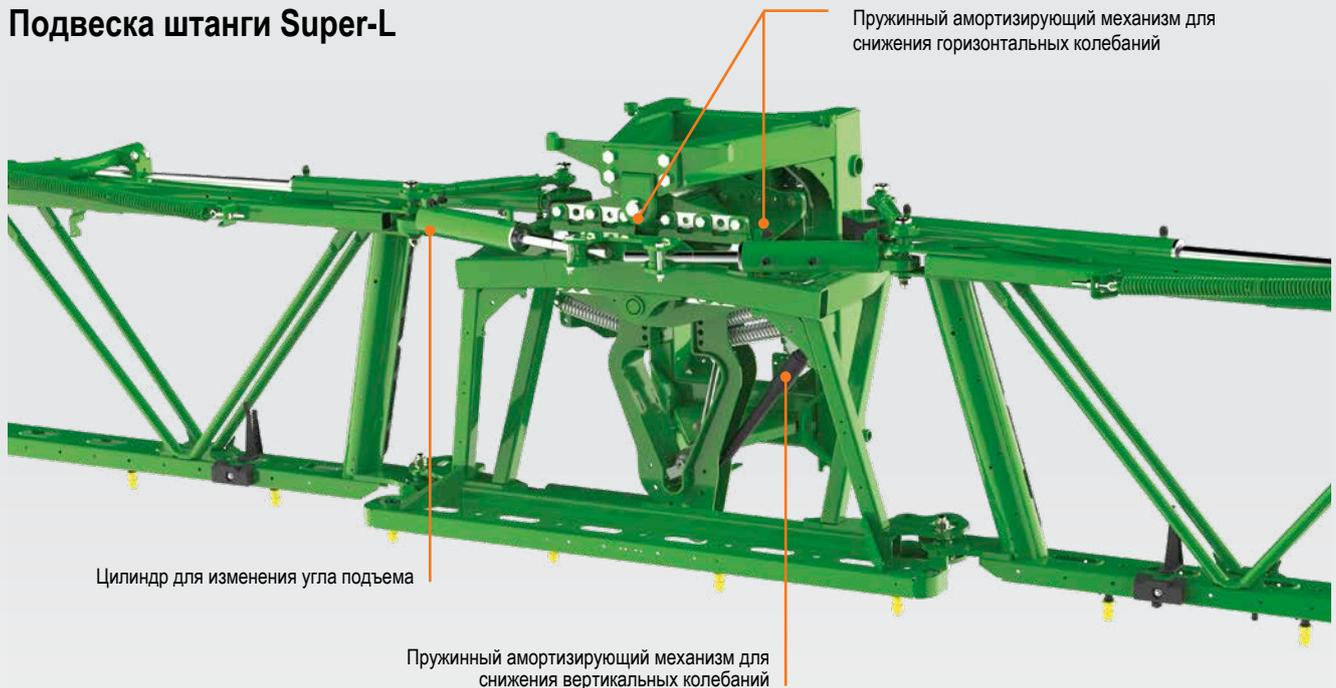
Пружинный амортизирующий механизм для снижения горизонтальных колебаний
