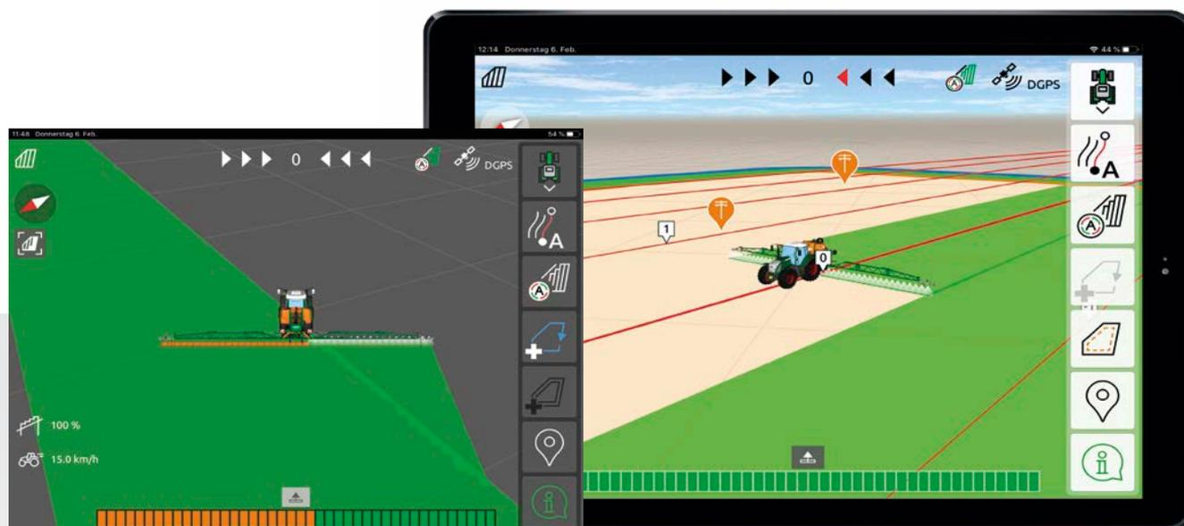
Вид карт с AmaTron Twin – Наглядное изображение эксплуатируемой машины и ее секций, а также кнопки на правой стороне дисплея планшета
