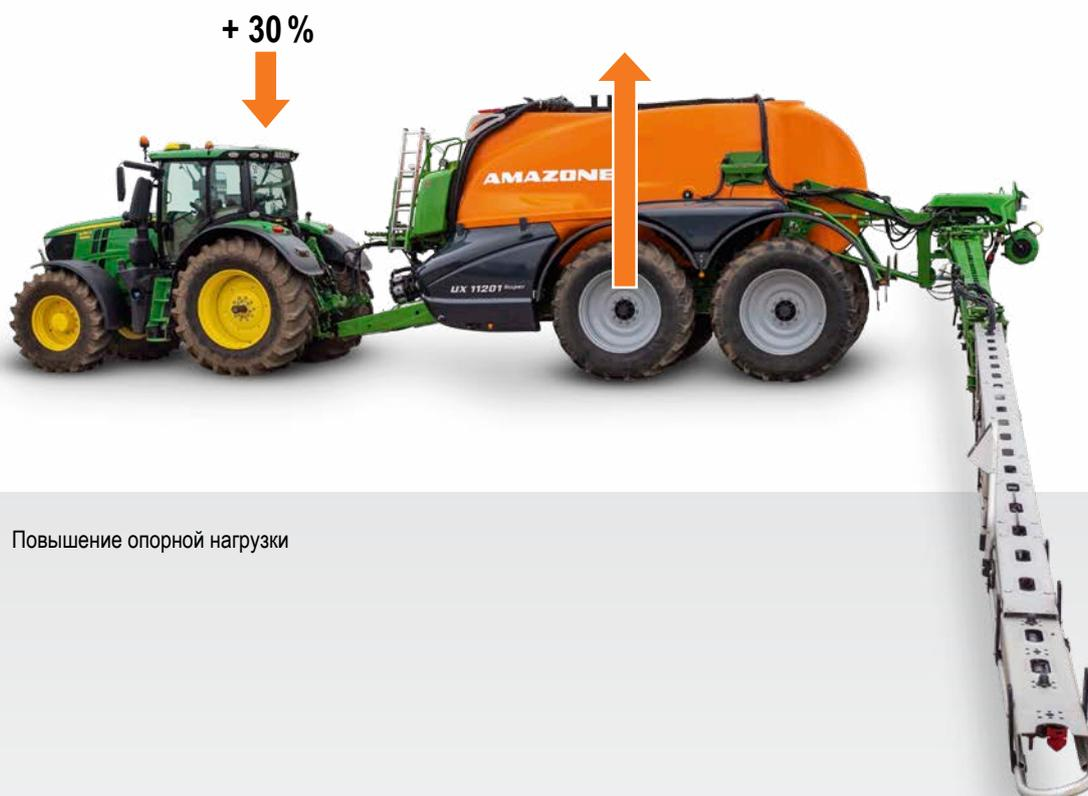
Повышение опорной нагрузки
