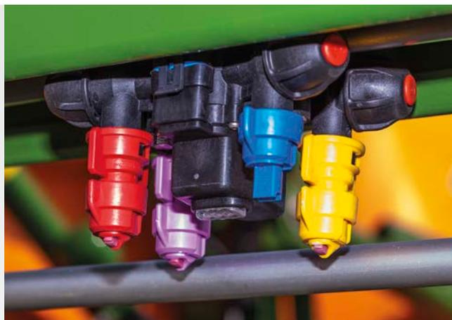
✔ Электрическое пофорсуночное включение AmaSelect
