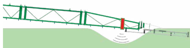
DistanceControl при оснащении двумя датчиками: на полеглых посевах штанга может погружаться в посевы
