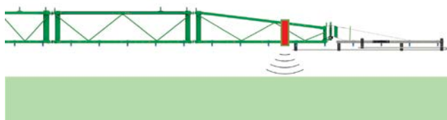
DistanceControl при оснащении двумя датчиками: Измерение на посевах
