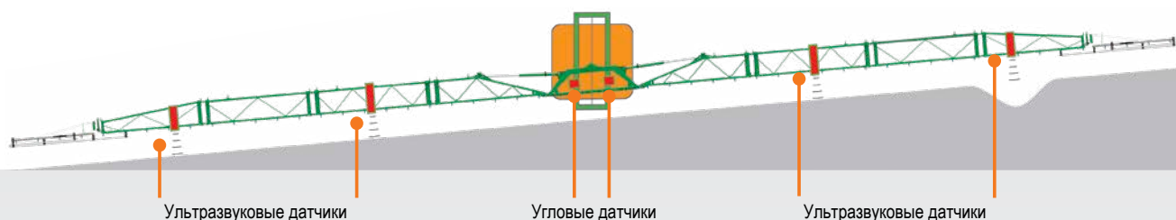
DistanceControl plus: Помощь в тяжелых условиях за счет оснащения четырьмя датчиками
