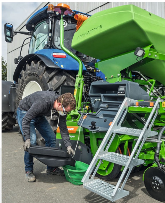
Комфортное опустошение калибровочного лотка
