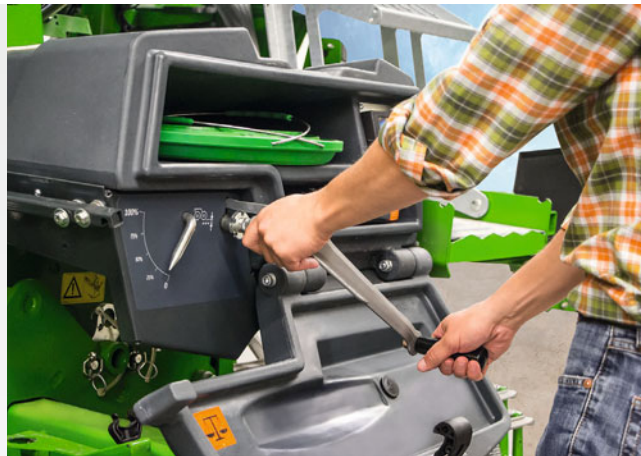
Централизованная настройка глубины укладки
