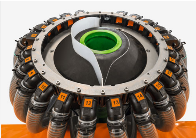
Сегментная распределительная головка с электрическим односторонним включением (активировано)
