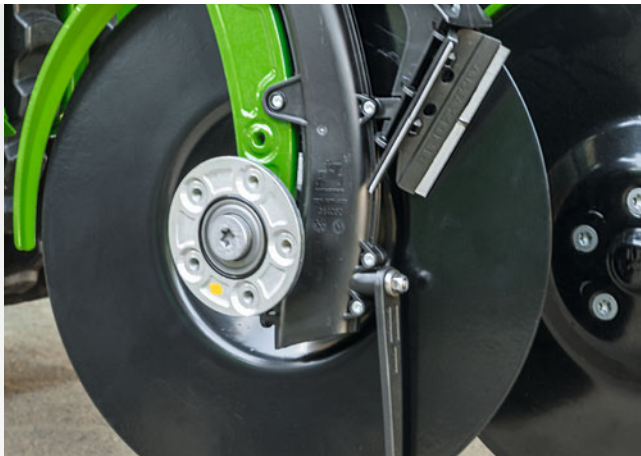
Твердосплавные внутренние чистики для связных, глинистых почв обеспечивают беспрепятственный ход сошника
