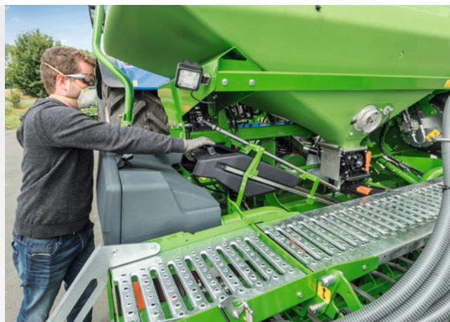
Выдвижной калибровочный лоток
