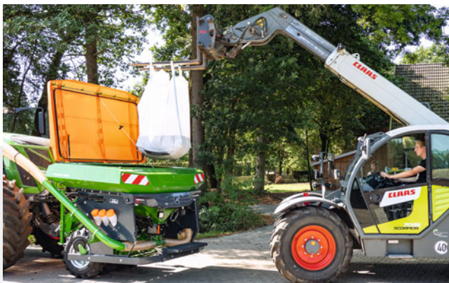
Большое отверстие бункера 1,10 м x 2,20 м для быстрого и простого заполнения FTender
