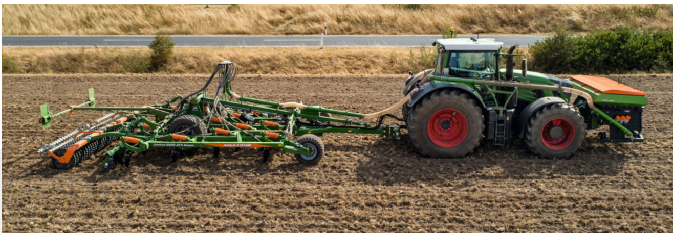
Фронтальный бункер FTender 1600 с прицепным культиватором Senius-2TX
