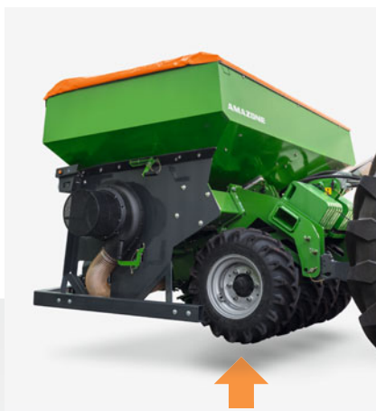
FTender с фронтальным шинным пакером T-Pack F в транспортном положении
