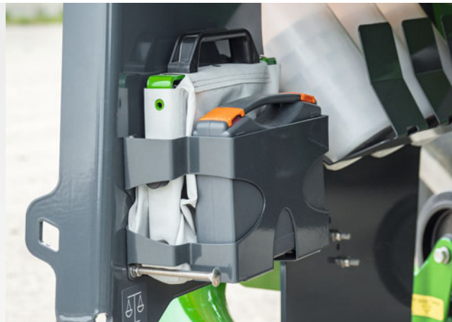
Серийный комплект для калибровки на машине
