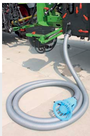
Заполнение через всасывающий шланг
